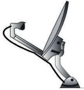
चित्र 4.3.4: एलएनबीएफ के साथ केबल का कनेक्शन
